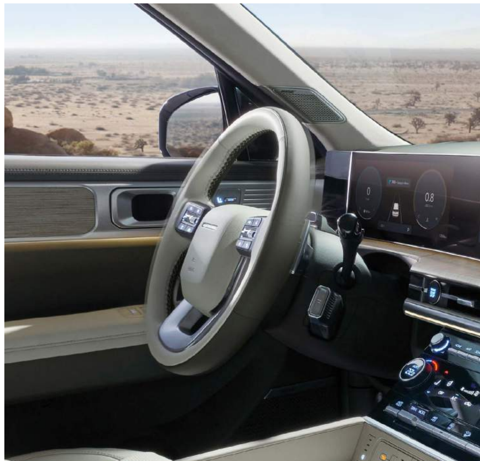
Рулевое колесо с датчиком положения рук
