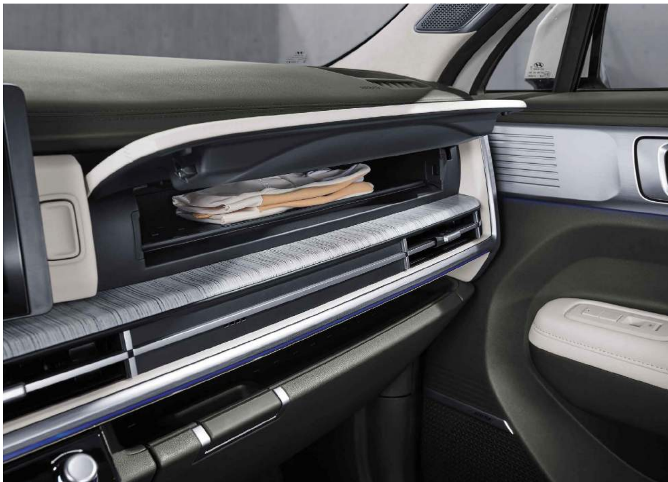
Отсек в центральной консоли с функцией дезинфекции вещей ультрафиолетом
