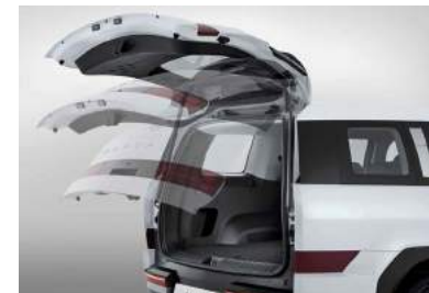
Интеллектуальная система открывания багажника (с регулировкой высоты)
