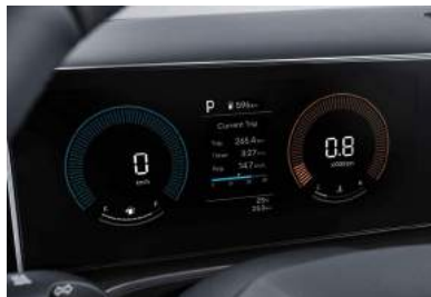
4,2-дюймовый ЖК-дисплей панели приборов
